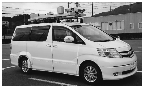
図8 MMSを搭載した移動体三次元形状計測車両（三菱電機（株）西川啓一氏提供）
