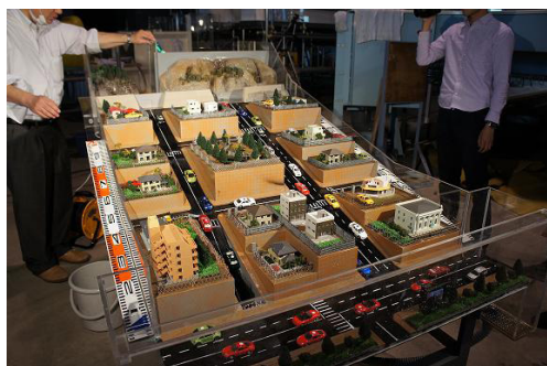
写真5-4 小スケールの急傾斜市街地模型
