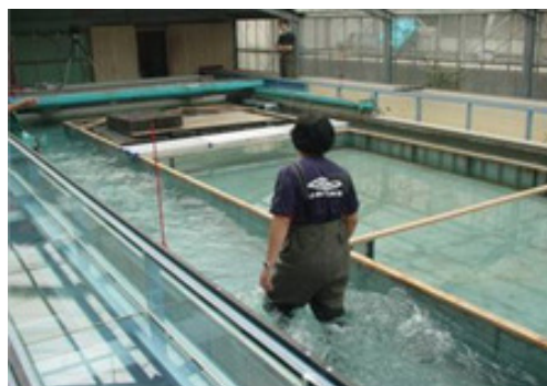
写真6-4 通路模型（幅1 m、30m）
