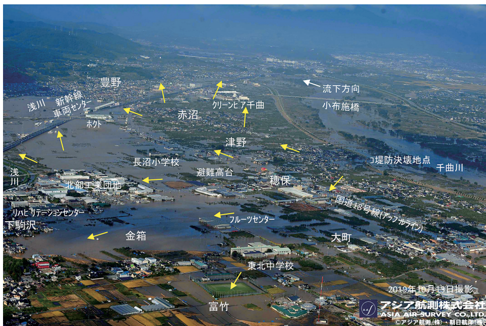
写真3 南西方向から北東側の長野市の千曲川左岸の浸水地域を写した空中写真（アジア航測株式会社，2019年）（矢印は，筆者らの現地調査において水稻の倒伏方向や砂塵の痕跡等から推定した氾濫流の流出方向）
