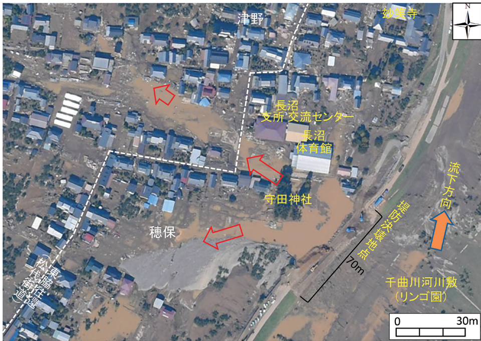
写真5 千曲川の堤防決壊地点付近の空中写真(国土地理院, 2019年10月16日)(矢印は氾濫流の流出方向)
