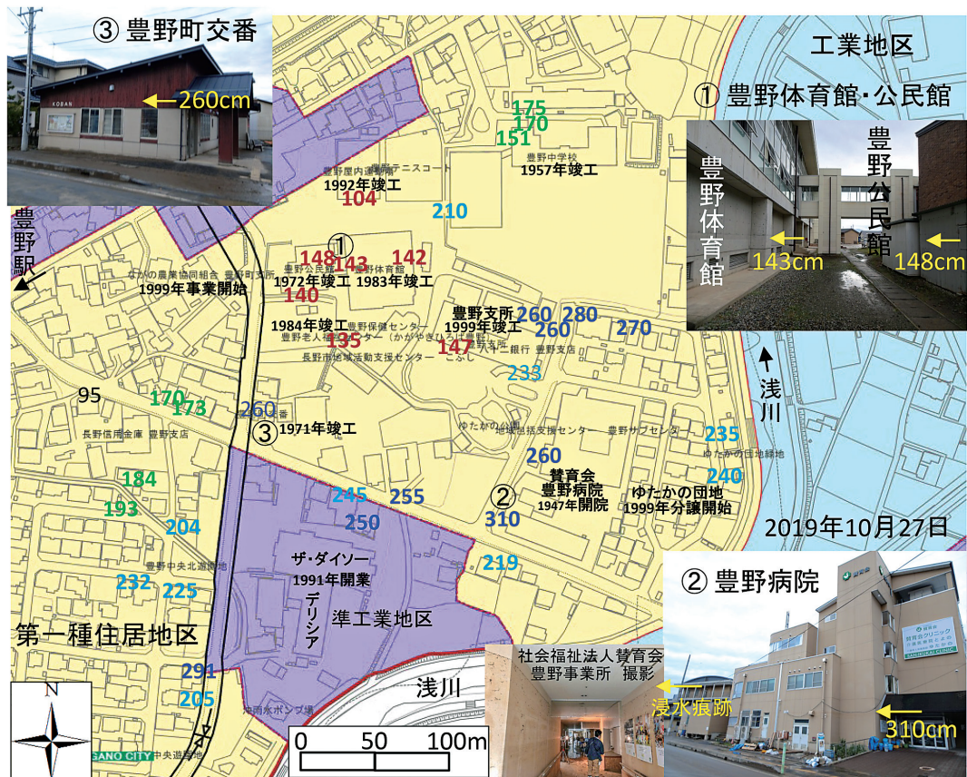
図12 豊野地区(旧豊野町)の公共施設が立地する中心部の地図と現地調査により得られた浸水深(cm), 浸水痕跡の写真(①~③)
