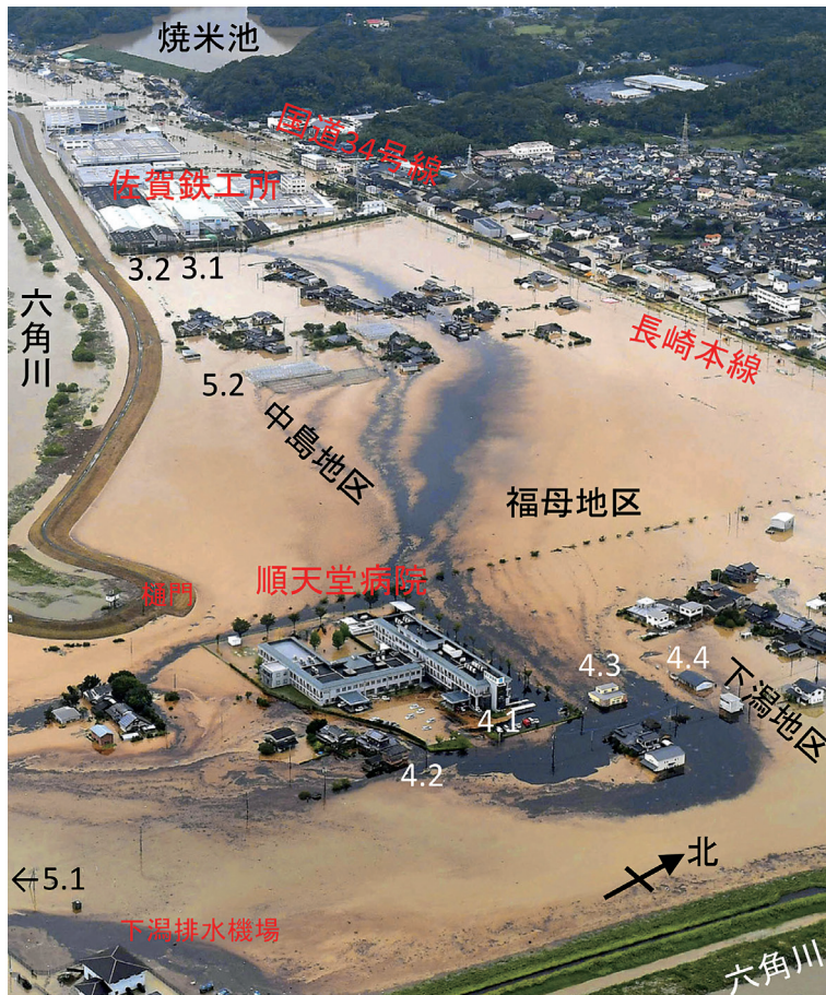
写真3 大町町の浸水と佐賀鉄工所から流出した油の状況 (共同通信社 (2019a), 2019年8月28日撮影) (写真中の数字は写真番号と一致, 地名等は筆者らが加筆)
