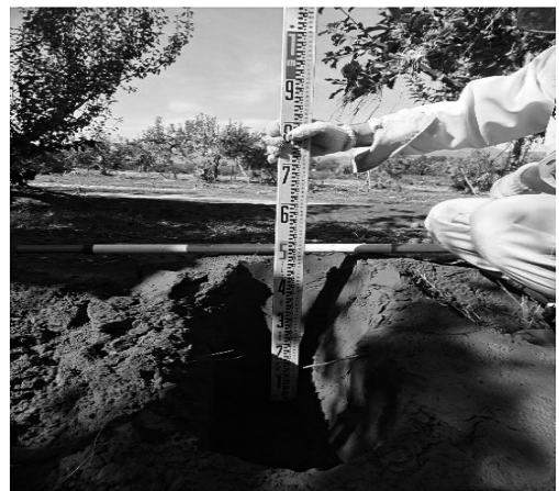
図19 リンゴ果樹園の土砂堆積深計測（筆者撮影）
