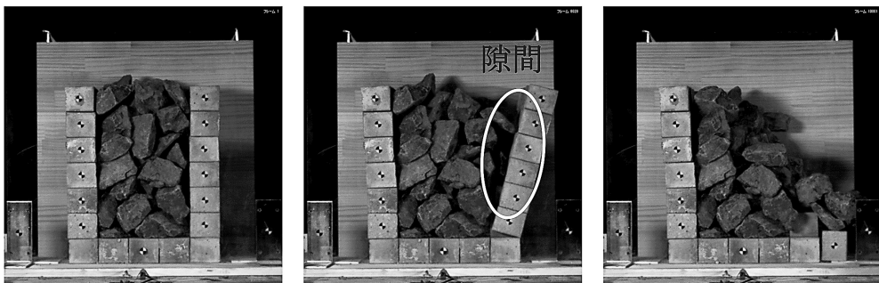
(d) ケース 8 (8Hz, Large) 加振後 32.1 秒, 170gal で崩壊
