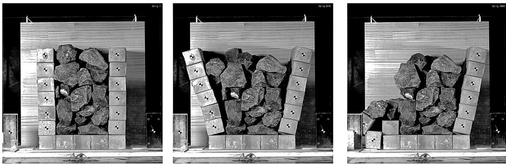
(b) ケース 2 (2Hz, Large) 加振後 32.4 秒, 140gal で崩壊
