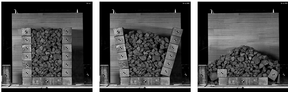
(c) ケース 7 (8Hz, Small) 加振後 24.2 秒, 160gal で崩壊
