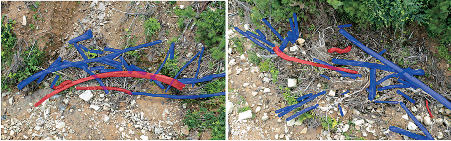
図3 上空から撮影した写真による流木の直線形状と曲がり形状の判別事例(青:直線形状, 赤:曲がり形状)
