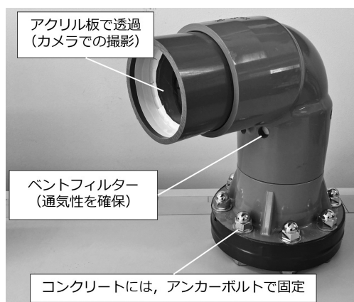
図 3 IoT センサを収納するケースの一例
