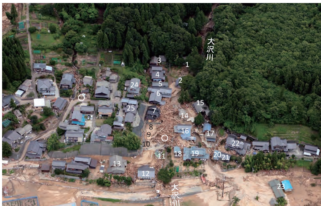
空中写真2 土石流が発生した小岩内地区の大沢集落における被害状況（アジア航測株式会社・朝日航洋株式会社，2022）（1～25は建物で，図13，空中写真3，写真1と一致。○は土石流危険渓流の標識位置（左上が大小沢，中央が大沢川））
