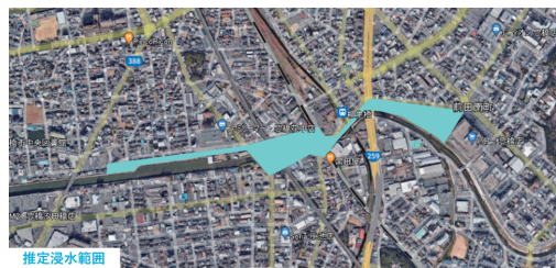
図7 柳生川における推定浸水範囲の結果（痕跡高調査、住民への聞き取りを元に描画） Google Earthの背景画像に描画
