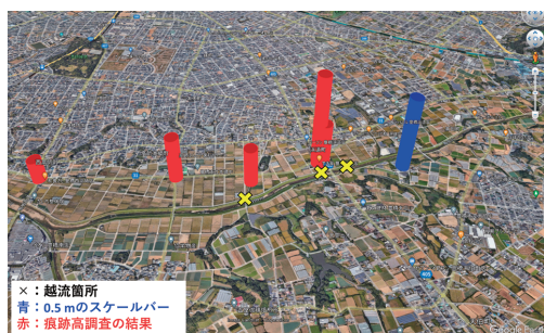
図8 梅田川における痕跡高調査の結果(青：0.5 mのスケールバー，×印：越流箇所) Google Earthの背景画像に描画
