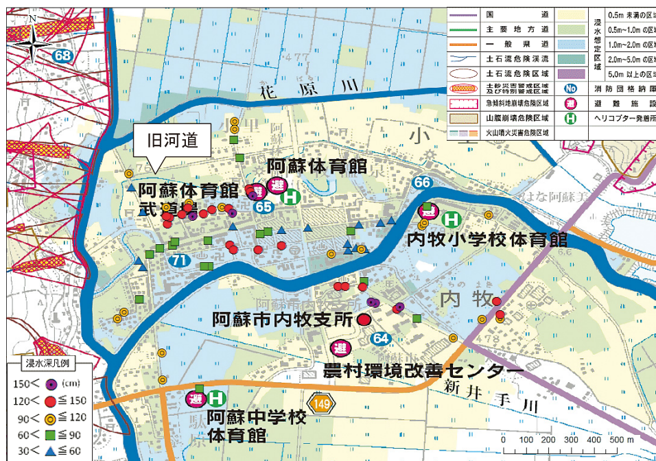
図10 阿蘇市が作成した洪水ハザードマップと現地調査より得られた浸水深 (cm) (阿蘇市防災マップに浸水深を加筆)
