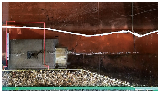
写真3 潜堤背後の越流状況 (Case3)
