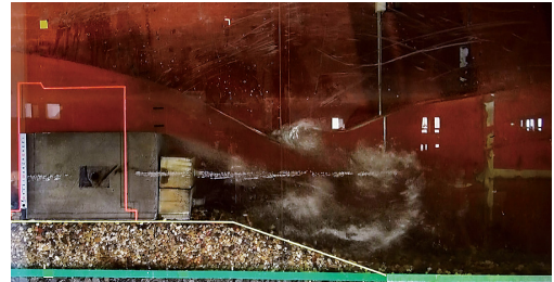
写真6 津波高が大きくなった場合の背後の渦の様子 (Case1)
