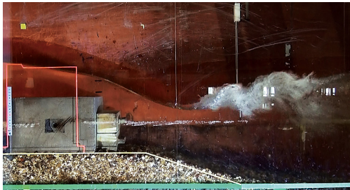
写真5 津波高が大きくなった場合の背後の渦の様子 (Case3)
