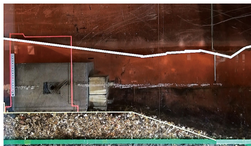
写真4 潜堤背後の越流状況 (Case1)
