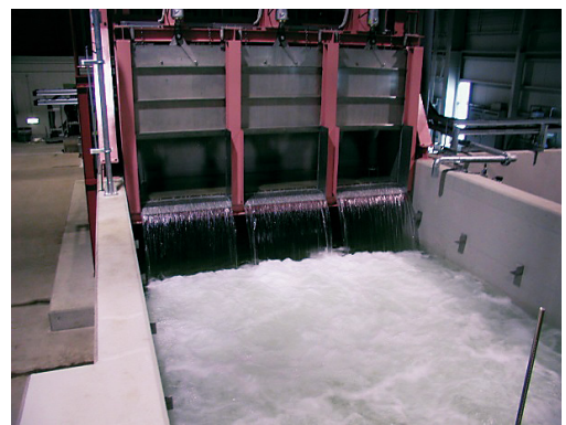
写真4 落下式津波発生装置の外観
