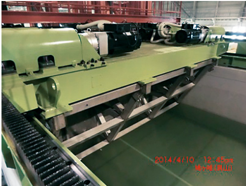
写真2 ピストンタイプ造波機の駆動部
