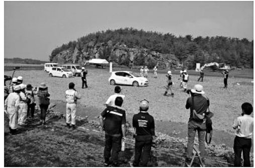
写真4-5 大量の軽石・火山灰を想定した車両走行実験
