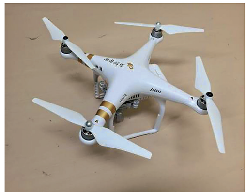
図2 本調査で使用した UAV (Phantom 3)
