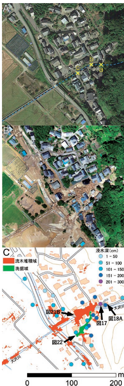
図16 小岩内の被災状況 (A) 発災前の2021年10月に撮影された衛星画像 (Google Earth)。(B) UAV-SfM 測量によって作成したオルソモザイク画像 (2022年8月5日撮影)。(C) 浸水深・流木堆積範囲・洗掘域の分布。黒矢印は写真の撮影地点と方向。
