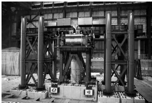
写真10 E-ディフェンスにおける橋梁耐震実験
