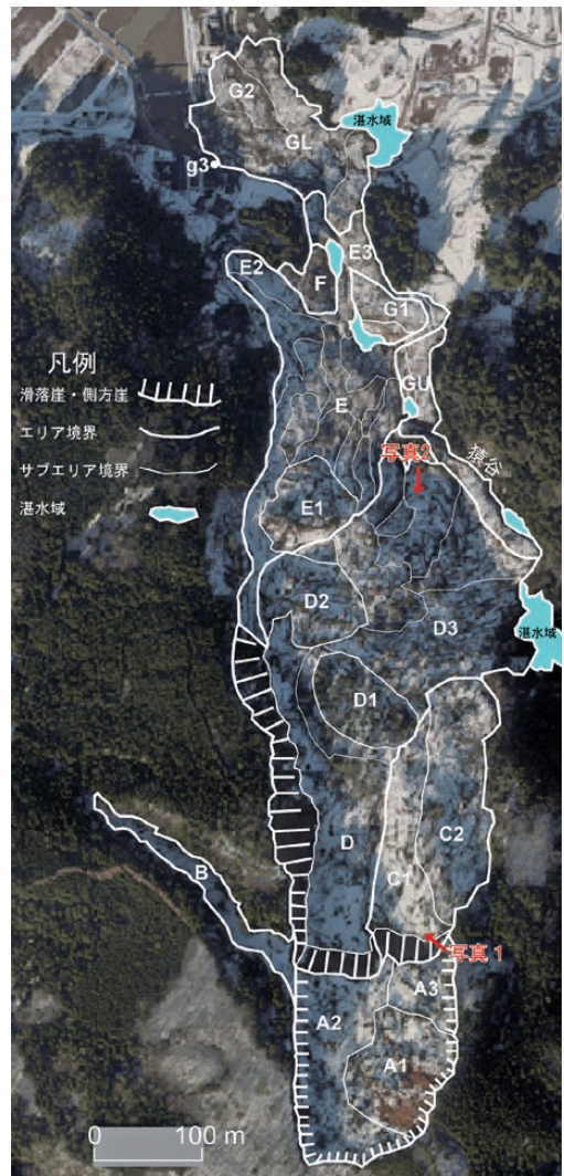
図2 市ノ瀬町の斜面崩壊の地形区分図。国土地理院の空中写真(C03-0050, 2024年1月11日撮影)に加筆。赤矢印は, 写真1と写真2の撮影位置と方向をそれぞれ示す。
